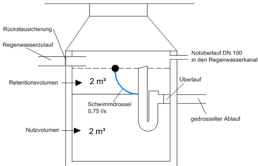
Beim Einsatz von Zisternen für die Hauswassernutzung bzw. zur Gartenbewässerung ist auf die Einhaltung der Trinkwasserverordnung (TrinkwV) § 13 Abs. 4 und § 17 Abs. 6 hinzuweisen. Die nach § 17 TrinkwV erforderlichen Vorgaben, wie strikte Trennung der beiden Leitungssysteme, Beschilderung der Zapfhähne, die von Brauchwasser gespeist werden, müssen auf jeden Fall erfüllt sein.
