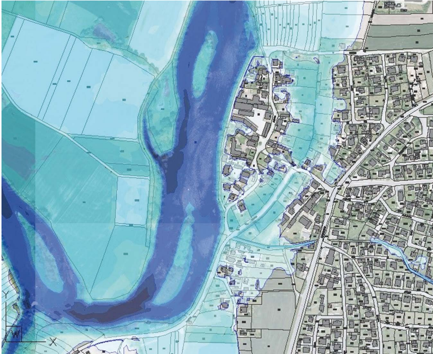
Hochwassersituation Katzdorf; aktueller IST-Zustand im Falle eines „HQ 100“ (Quelle: EBB Ingenieurgesellschaft mbH)
